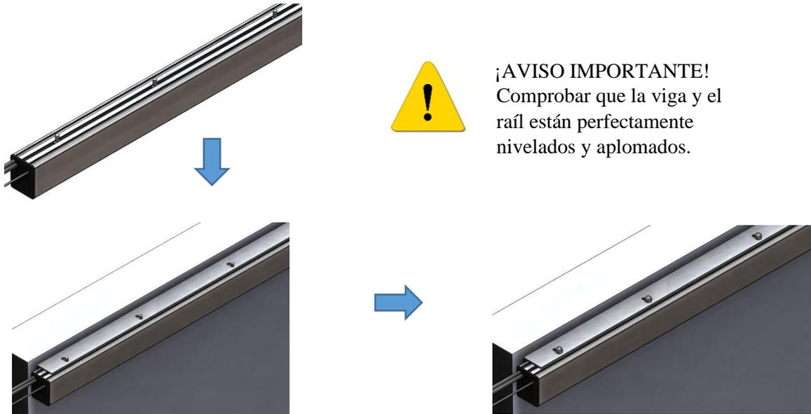
Nota: En caso de requerir instalar una estructura portante, la alineación del ángulo de fijación a pared con respecto a la viga se hará como se indica en la siguiente figura:
