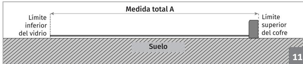
**11.** Aún en el suelo, junte el vidrio (ya con la pinza colocada) al cofre. Quite la medida total entre a límite inferior del vidrio al límite superior del cofre. Tenga la atención al nivelamento.
